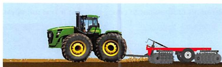
1. Заднего навесного устройства, налаженного по трехточечной схеме.
